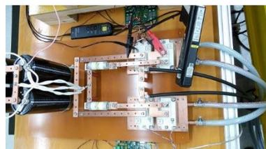
試作インバータ回路
