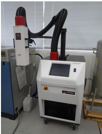
入力された圧縮エアーを素早く温度コントロールし、エアーノズルから検査対象物に噴射
