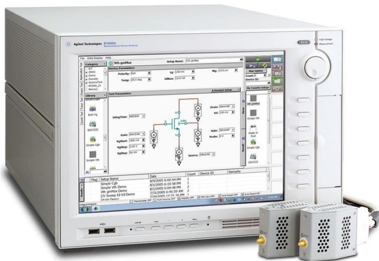
半導体の高精度な電圧電流特性の評価が可能
